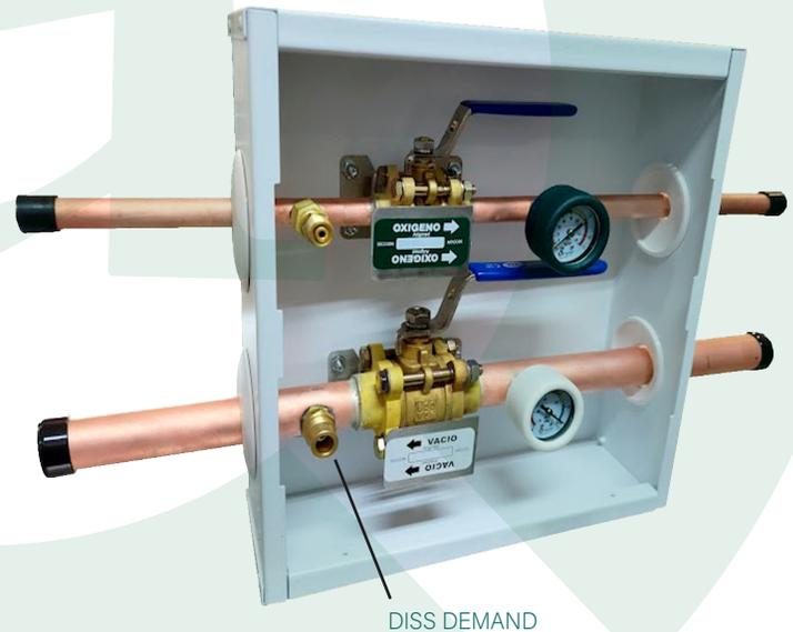
● **Puertos de Emergencia:** Puede incluir conexión roscada **DISS DEMAND** del gas específico (con válvula check), para alimentación externa de emergencia de las áreas controladas por la caja de válvulas. Incluye puertos roscados hembra de 1/8" NPT para acoplamiento de manómetros y vacuómetros análogos.
